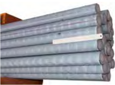
Umlaufende Ziehmarken in einem Abstand von 55 mm
