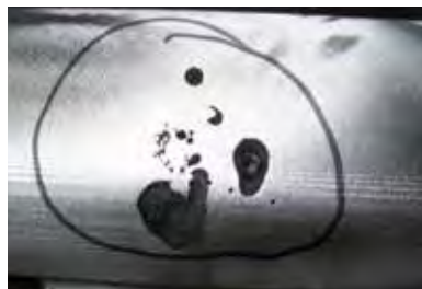
Kleine und große Schlackeeinschlüsse
