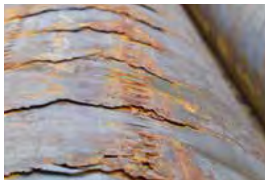
Ziehschrittüberlappung an einem runden Halbzeug
