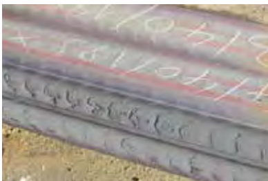
Ziehschrittüberlappungen an einem rechteckigen Halbzeug
