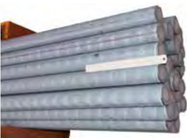
Umlaufende Ziehmarken in einem Abstand von 55 mm
