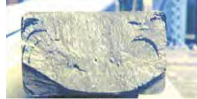
Bruchfläche mit Weißeinstrahlung
