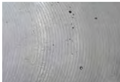
Gasblasen unterschiedlicher Größe
