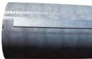
Markierungen der Zieheinrichtung parallel beidseits des Stahlmaßstabs
