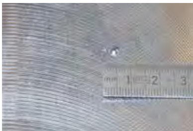
Gasblase mit glatter glänzender Oberfläche
