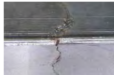
Ziehschrittüberlappung, teils nach Bearbeitung
