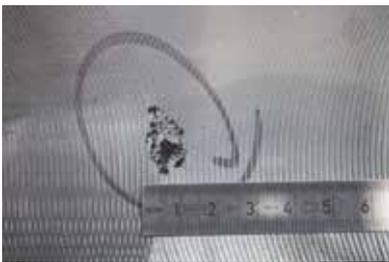
Schlackeeinschluss mit zerklüfteter Oberfläche
