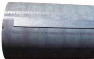
Markierungen der Zieheinrichtung parallel beidseits des Stahlmaßstabs
